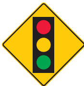
Feux de signalisation devant
