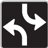
Les véhicules venant des deux sens doivent tourner à gauche, il est interdit de continuer tout droit
