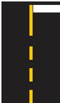
Ligne d'arrêt — immobilisez-vous avant cette ligne
