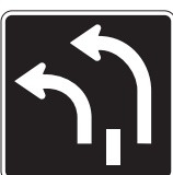
Les véhicules dans ces deux voies doivent tourner à gauche
