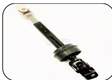
Colonne de direction qui se rétracte de façon télescopique
