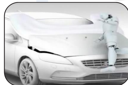
Dispositif de protection piéton
