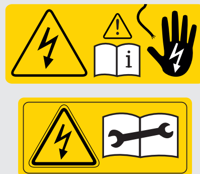
Exemple : Signaux de danger sur modules et pièces
