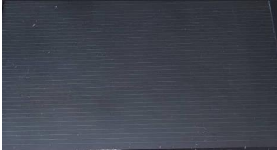
Photo 6 : Surface d'un panneau solaire photovoltaïque amorphe
