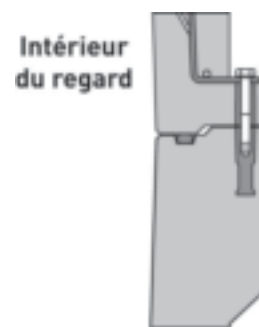
Assemblage des regards verrouillés
