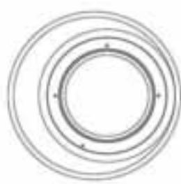
Profil standard joint auto-lubrifié Forsheda F 116
