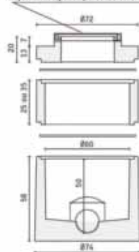
Tampon fonte hydraulique 50x50 ou 40x40 scellé - 125 KN
