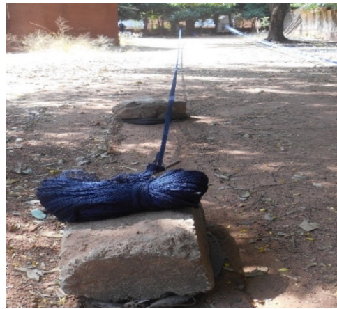
Photo 4 : Lot de fils des 2 lisses tendus par un socle
