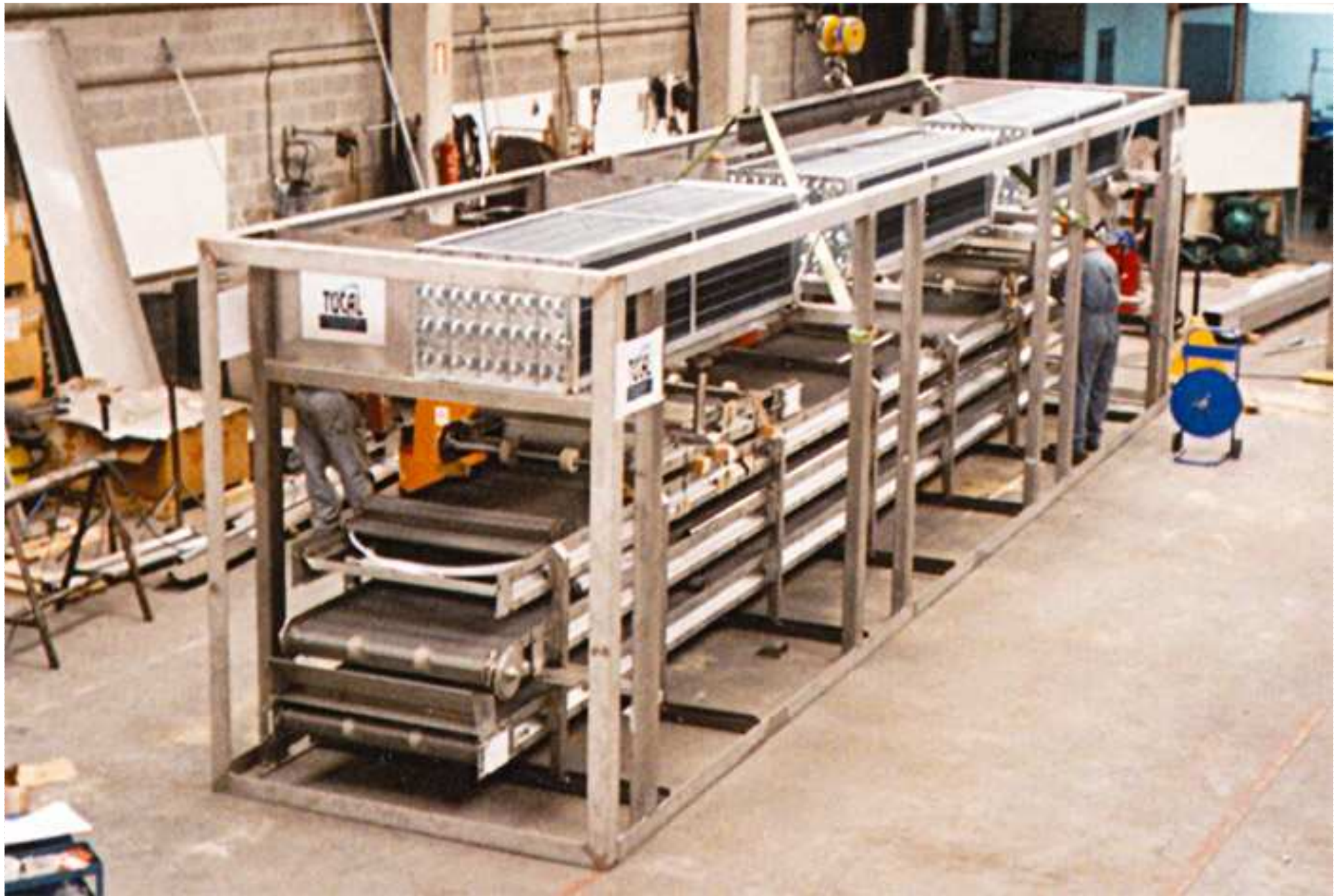
Exemple de tunnel de surgélation
